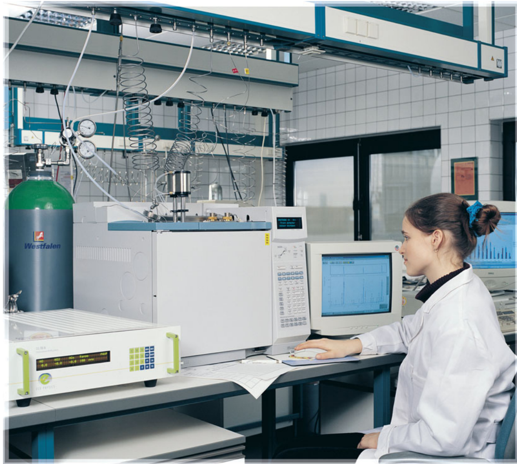
Zur Quantifizierung kundenindividueller Rezepturen kommen im Sondergasezentrum der Westfalen AG unterschiedliche Analysensysteme zum Einsatz.
