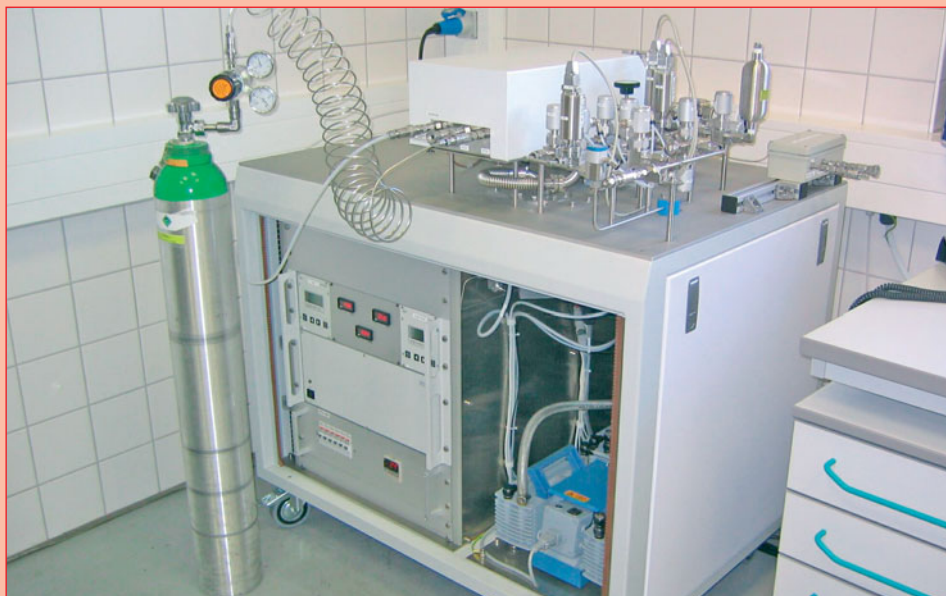
Das GAM 400-Massenspektrometer mit verschiedenen Einlasssystemen deckt den Massenbereich zwischen einem und 300 amu ab.
